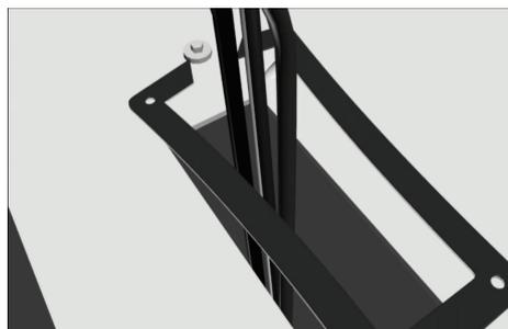
17. Installieren Sie alle vorkonfektionierten Kabel, nachdem Sie einen schrägen Schnitt in die Dichtung gemacht haben, und sichern Sie die Dichtung am Schrankausschnitt.
